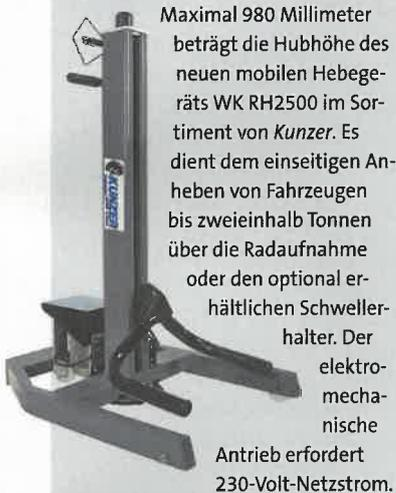
Maximal 980 Millimeter beträgt die Hubhöhe des neuen mobilen Hebegepärs WK RH2500 im Sortiment von **Kunzer**. Es dient dem einseitigen Anheben von Fahrzeugen bis zweieinhalb Tonnen über die Radaufnahme oder den optional erhältlichen Schwellerhalter. Der elektromechanische Antrieb erfordert 230-Volt-Netzstrom.
