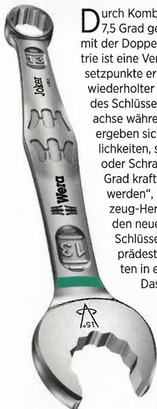
Durch Kombination des um nur 7,5 Grad geschwenkten Mauls mit der Doppelsechskant-Geometrie ist eine Verdopplung der Ansetzpunkte erreicht worden. Bei wiederholter 180-Grad-Drehung des Schlüssels um die Längsachse während des Schraubens ergeben sich vier Ansetzmöglichkeiten, so dass Muttern oder Schraubenköpfe alle 15 Grad kraftschlüssig gepackt werden“, verspricht Werkzeug-Hersteller Wera für den neuen Ring-Maul-Schlüssel Joker 6003. Dies prädestiniere ihn für Arbeiten in engen Bauräumen.
