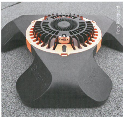
Ab einer bestimmten Anstauhöhe hebt sich das Laubsieb durch Notauslösung.
