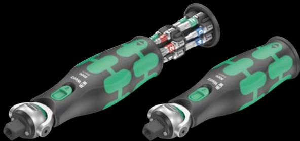
13点セット; 9.5mmソケットおよび9.5mm四角差込接続に対応 ZyklopPocket8009、DIN ISO1173-C6.3およびE6.3、ヴェラコネクションシリーズ1および4に準拠した6.35mm六角差込を備えたビットにも適しています。9.5mmラチェットおよび6.35mmビットラチェットドライバー; 首振りラチェット 左右に0°、15°、90°のデフォルト回転; 首を0°の位置に固定したらドライバーとして使用できます; 時計回り/反時計回りの切り替え、細かいギア、5°の小さな振り幅; 磁気による 取付。疲労軽減のための多種材質でできたKraftformハンドル; ハンドルに内蔵されたビット12本収納するロータリー式マガジン、6.35mm、長さ25mm。
