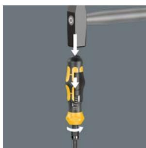
インパクトレンチ機能をオンにすると、ハンマーによる衝撃が最大25Nmの緩みトルクに変換される。貫通軸を介して力の伝達を保つ。
