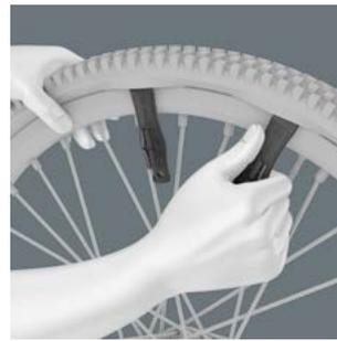
ガラス繊維強化プラスチック製タイヤジャッキを使用すると、リムを損傷することなく、タイヤを安全にリムから外すことができます。1つのタイヤジャッキでリムを持ち上げ、スポークに引っ掛け、底部のタイヤジャッキでタイヤを引き抜く。2つのタイヤジャッキは一緒にクリックできるため、個別に紛失することはない。
