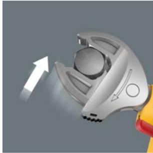
Joker 6004 電気工事用絶縁自動調整モンキーラチェットレンチは、自動的かつ継続的に平行な開口をつかむことで、潜在的な動作範囲内のすべての寸法をカバーする。ボルトまたはネジに取り付くときに、必要なサイズを自動的に識別する。
