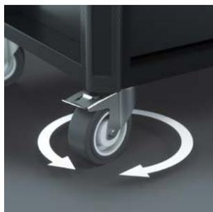
Le 2 ruote piroettanti sono dotate di un doppio arresto: la ruota frenata ne impedisce in modo affidabile lo spostamento, il cuscinetto rotante frenato impedisce alle ruote di ruotare involontariamente, ad es. su superfici in pendenza. I rulli elastici resistenti agli oli e agli acidi garantiscono un funzionamento regolare. Un anello protettivo impedisce l'ingresso di sporco e fili.
