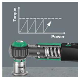
La chiave dinamometrica Safe-Torque A 1 è dotata di un meccanismo di blocco a slittamento. Al raggiungimento del valore di coppia impostato l'utensile si blocca e quindi non è possibile applicare una coppia eccessiva.
