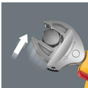
Grâce à ses mors parallèles à réglage automatique sans paliers, la clé à fourche Joker 6004 VDE couvre toutes les dimensions du domaine d'application concerné. La clé s'ajuste d'elle-même, sans réglage, à la taille nécessaire au contact de l'écrou ou de la vis.
