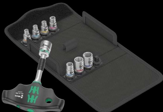
Jeu de 9 pièces dans une housse textile. 1 tournevis adaptateur à manche en T 411 A RA avec fonction cliquet pour douilles 1/4". 8 douilles, 1/4", avec repère d'outils « Take it easy » : code couleur en fonction de la taille.
