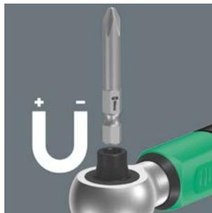
La clé dynamométrique Safe-Torque A 2 présente une admission d'embout 1/4" avec puissant aimant permanent et convient aux embouts à emmanchement hexagonal 1/4" selon DIN ISO 1173-C 6,3 et E 6,3 et aux séries Wera 1 et 4.
