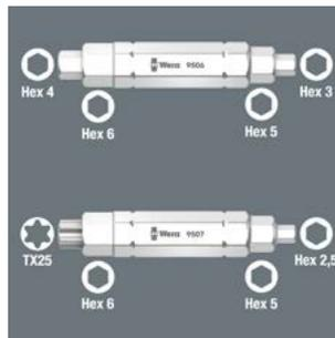
Con ayuda de las puntas cuatro-en-una 9506 y 9507 se pueden accionar cuatro tamaños de tornillos respectivamente. Con la punta cuatro-en-una 9506 son cuatro tamaños de tornillos de hexágono interior (3,0; 4,0; 5,0; 6,0), con la punta cuatro-en-una 9507 son tres tamaños de tornillos
