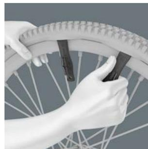
Con ayuda de las llaves desmontaneumáticos de material plástico con refuerzo de fibra de vidrio, es posible levantar los neumáticos de manera segura de la llanta haciendo palanca, sin causar daños en la llanta. Con una de las llaves desmontaneumáticos levantar el neumático de la llanta, engancharla
