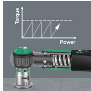
La llave dinamométrica Safe-Torque A 1 está equipada con un mecanismo de sobre-resbalo. Tan pronto se alcanza el valor de par de giro preajustado la herramienta ya no puede ser utilizada para apretar de manera forzada. Así queda excluido que se aplique un valor de par demasiado alto.
