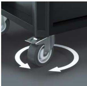
Las 2 ruedas giratorias están equipadas con un doble bloqueo: la rueda giratoria frenada evita de forma fiable que el carro se ruede, y el rodamiento giratorio frenado evita el giro indeseado de las ruedas giratorias, por ejemplo, en superficies inclinadas. Las ruedas son elásticas, y además resistentes a aceites y ácidos, y proporcionan una marcha muy suave. Un anillo protector evita la entrada de suciedad y de hilos en los rodillos.
