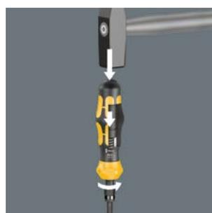
Cuando está conectada la función de destornillador de golpe, el impulso de golpe del martillo es transferido a un movimiento de rotación con un par de desapriete de hasta 25 Nm. La transmisión de la fuerza se realiza sin pérdidas por medio de una varilla pasante.
