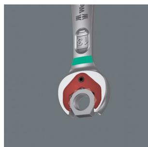
Con la funzione di ritenuta del Joker l'operatore riesce ad avvicinare le viti e i dadi in maniera sicura, direttamente fino al punto di avvitarmento. In questo modo è estremamente facile "imboccare" la filettatura. Le viti o i dadi non cadono più e non si deve più perdere tempo prezioso per la loro ricerca.
