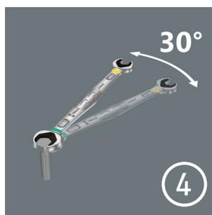
Вместо 60° Joker теперь имеет угол возврата всего 30° и механику двойного шестигранника. Благодаря этому, а также своей прямой головке, Joker избавляет вас от лишних поворотов ключа. С помощью Joker теперь можно вывинчивать, контрить и затягивать болты и гайки в ситуациях, когда беспомощны обычные инструменты. Комбинация упора и
