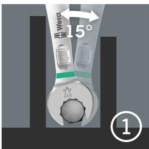
Комбинированный гаечный ключ Joker 6003 с особой формой рожковой части - наклоном на 7,5° и профилем в виде двойного шестигранника - увеличивает вдвое возможности для накидывания ключа при повторных поворотах ключа в процессе завинчивания на 180° относительно продольной оси. Гайка или головка винта захватывается через каждые
