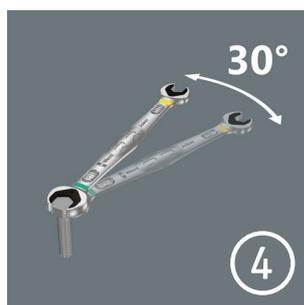
狭いスペースで、ボルトやナットを締めたり緩めたりするには、一般の回転角60°で裏返しながら作業する必要があります。ジョーカーの特別なダブルヘックスデザインにより、回転角が30度になり、裏返す必要がなくなります。ジョーカーは、一般のスパナレンチが利用できない狭いスペースで重宝されます。リミットストップは錆びたボルトに食いつくこともできます。
