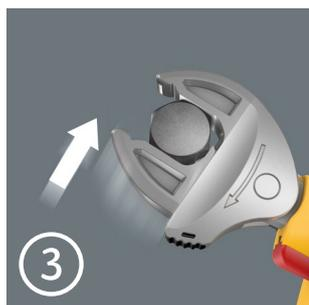
Joker 6004 電気工事用絶縁自動調整モンキーラチェットレンチは、自動的にかつ継続的に平行な開口をつかむことで、潜在的な動作範囲内のすべての寸法をカバーする。ボルトまたはネジに取り付くときに、必要なサイズを自動的に識別する。
