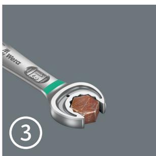
ジョーカーのダブルヘックスのスパナ形状により、ナットまたはボルトを落とさずに作業ができます。また、ジョーカーの開口部には交換可能な硬化金属製プレートが付いており、接触面に施された小さなギザ歯がしっかりと食いついて、錆びついたボルトを回すこともできます。その二つの機能を組み合わせることにより、より高いトルクをかけてもスリップするのを防ぎます。
