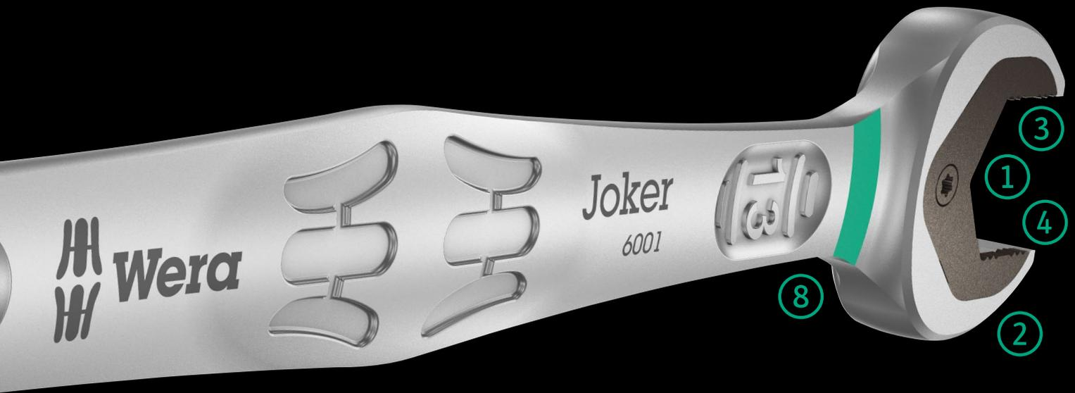
首振りラチェットヘッドとスイッチレバー付きジョーカーコンビネーションラチェットレンチ。通常のレンチより作業効率が向上、優れたデザイン。開口部にある交換可能な金属プレートにギザ歯を備えており、ナットやボルトにしっかり"食いつき"ます。リミットストップは、ボルトヘッドの滑りを防ぎ、より高いトルクを加えることができます。ダブルヘックス形状により、ナットまたはボルトをしっかりホールドでき、空間での作業も可能にします。作業
