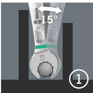
Der Ringmaulschlüssel Joker 6003 mit seiner besonderen Maulgeometrie – eine um 7,5° geschwenkte Maulseite und die Doppelsechskantgeometrie – verdoppelt die Ansetzmöglichkeiten bei wiederholter 180°-Drehung des Schlüssels um die Längsachse. Muttern bzw. Schraubköpfe können alle 15° „gepackt“ werden. Den jeweiligen Ansetzpunkt findet der Joker 6003 nach jedem Wenden sozusagen von selbst.
