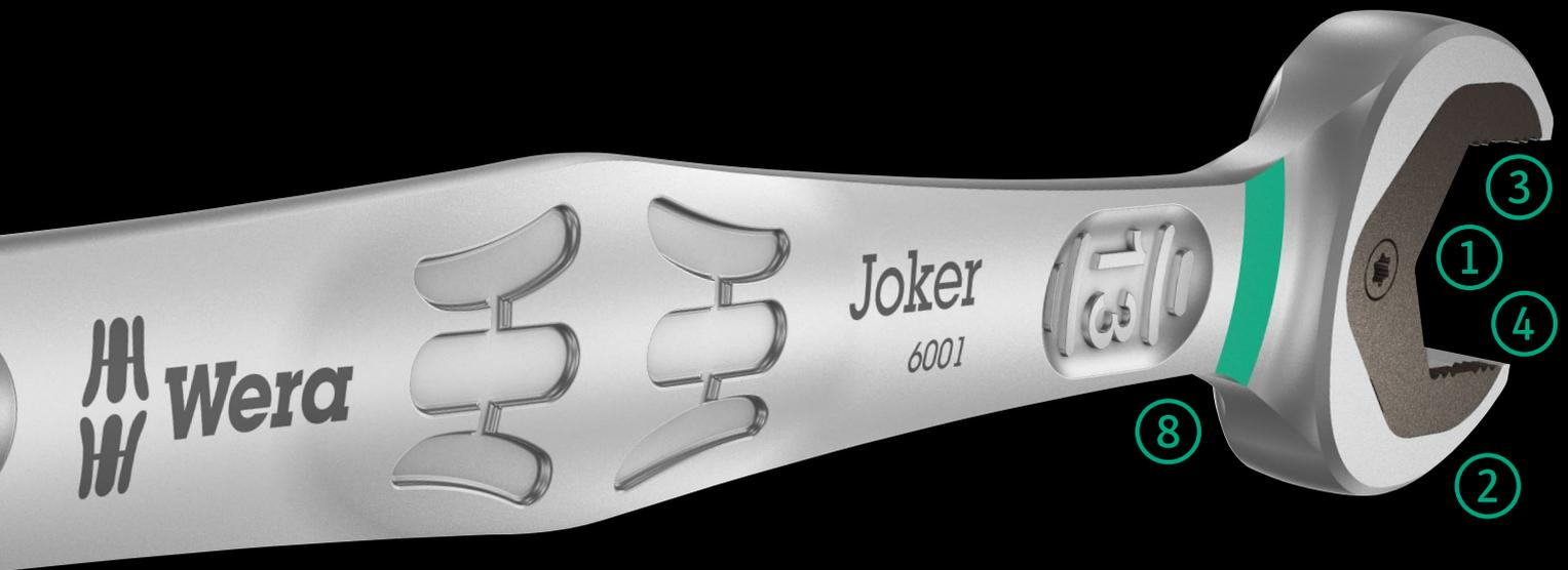
Joker Maulringratschenschlüssel mit abgewinkelter Ratschenseite und Umschalthebel. Mit Haltefunktion durch Metallplatte im Maul, die die Gefahr des Verlierens von Schrauben und Muttern reduziert.
