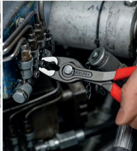
an der Maulspitze ausgestattet. Verzahnte Greifflächen unterstützen frontal das sichere Greifen, die hohe Übersetzung lässt die KNIPEX TwinGrip kräftig zu packen und so selbst stark abgenutzte Schraubköpfe leicht greifen, anziehen und lösen. Aber auch flache Werkstücke
